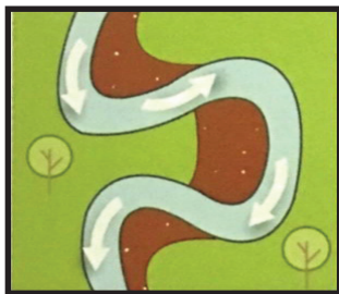
แม่น้ำโค้งตัว น้ำไหลจะทำให้เกิดการกัดเซาะและพัดพาตะกอนมาทับถมดังภาพ
